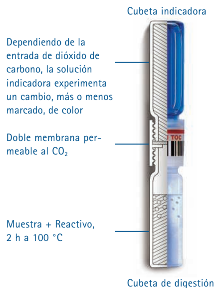
Fig. 3: Principio de funcionamiento de la cubeta-test TOC de LANGE.
