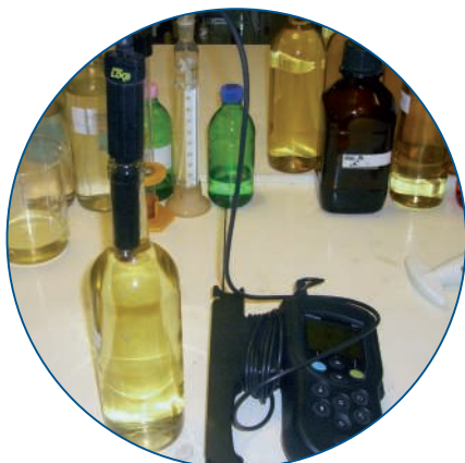
Fig. 3 y 4: Medida de oxígeno en una botella con el HQD y el sensor LDO.
