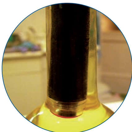
Fig. 3 y 4: Medida de oxígeno en una botella con el HQD y el sensor LDO.
