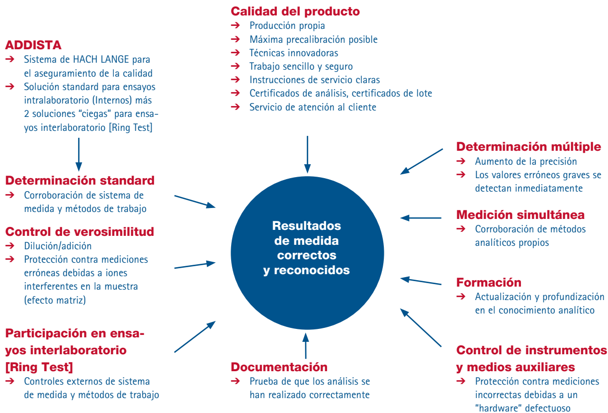
Fig. 2: Las distintas medidas de aseguramiento de la calidad y sus ventajas.
